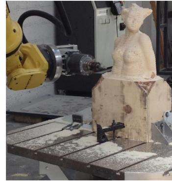
На протяжении многих лет Eureka является лидером в области программных решений для роботизированного фрезерования, позволяя объединить гибкость 6-осевого промышленного робота и надежные технологии многооперационных станков с ЧПУ для создания моделей и художественных объектов.
